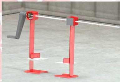
L'apristampo viene utilizzato per estrarre le bussole dalle colonne in maniera semplice e rapida, senza grande fatica.
